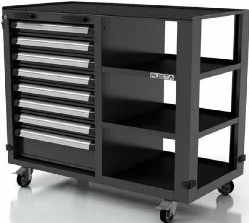
**IT** Stazione di lavoro mobile con 8 cassetti e 4 ripiani a giorno ricoperti di DCT antigraffio (resistente a benzina, acidi ed oli minerali). Completo di paraspigoli, 4 ruote girevoli, di cui 2 dotate di freno, maniglie ergonomiche laterali per la corretta movimentazione. Struttura completamente saldata. Nr. 7 cassetti alti 9 cm, Nr. 1 cassetto alto 18 cm.
